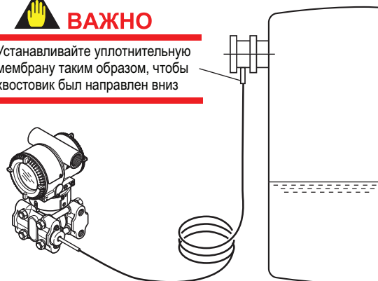
Рисунок 4.2 Установка мембранных разделителей на резервуаре
